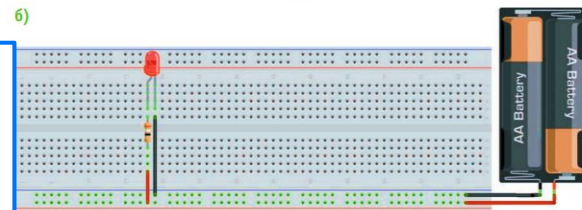
Рис. 4.4. Подключение светодиода: а — принципиальная схема; б — внешний вид
